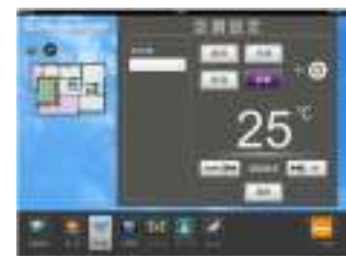
エアコン制御 (自動コントロール)
